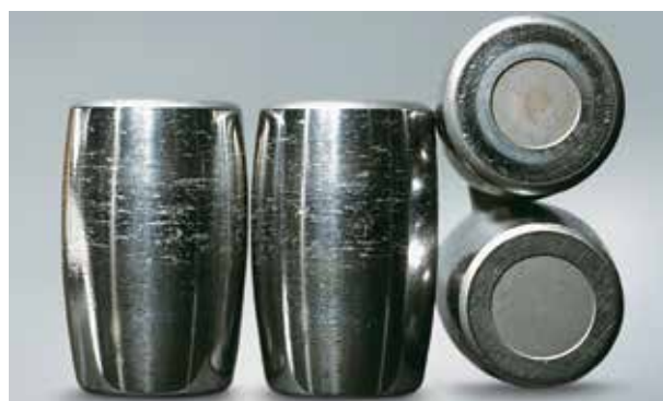
Фото 3.2 Деталь: Сферические ролики с фото 3.1 Симптом: Задир на краю ролика Причина: Проскальзывание роликов вследствие резкого ускорения и торможения
