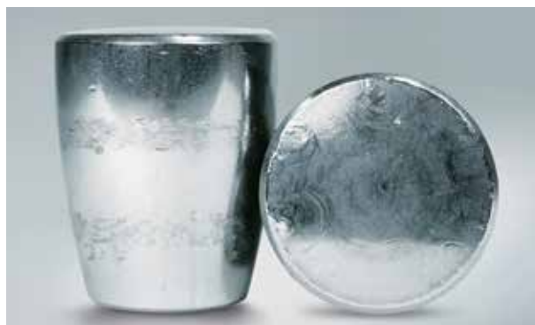
Фото 3.6 Деталь: Бочкообразные ролики с фото 3.5 Симптом: Задираание на краю ролика Причина: Частицы износа, попадающие на поверхность, и чрезмерная осевая нагрузка
