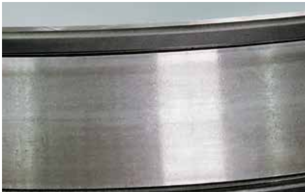
Фото 8.3 Деталь: Внутреннее кольцо конического роликоподшипника Симптом: Маленькие и большие вмятины по всей поверхности дорожки качения Причина: Инородные частицы попадают на рабочую поверхность
