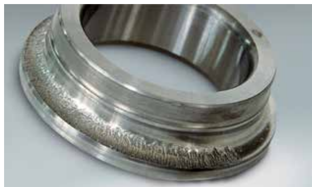
Фото 1.1 Деталь: Внутреннее кольцо радиально-упорного шарикового подшипника Симптом: Усталостное отслаивание на половине поверхности дорожки качения Причина: Недостаточная смазка вследствие попадания охлаждающей жидкости в подшипник
