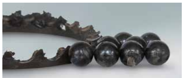
Фото 14.5 Деталь: Шарики и сепаратор с фото 14.3 Симптом: Сепаратор оплавился, шарики изменили цвет и оплаввились Причина: Чрезмерный предварительный натяг
