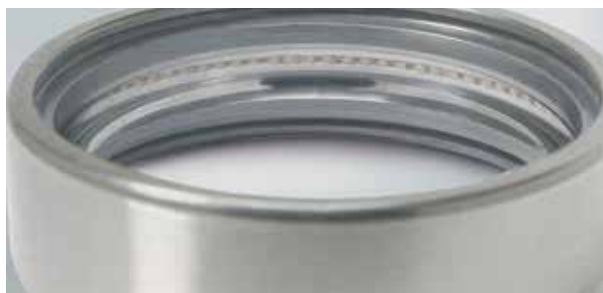
Фото 15.6 Деталь: Наружное кольцо шарикового подшипника Симптом: Рефлексия на поверхности следов вращения (высокой частоты)
