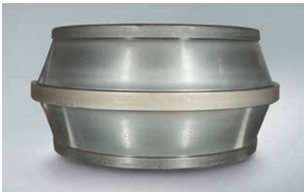
Фото 8.1 Деталь: Внутреннее кольцо двухрядного конического роликоподшипника Симптом: Матовая поверхность следов вращения Причина: Инородные частицы попадают на рабочую поверхность
