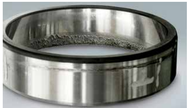
Фото 1.8 Деталь: Наружное кольцо с фото 1.7 Симптом: Усталостное отслаивание только одного следа вращения по всей периферии Причина: Чрезмерная осевая нагрузка
