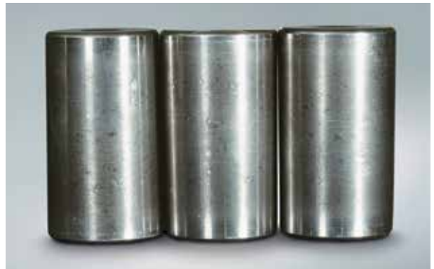
Фото 8.4 Деталь: Бочкообразные ролики с фото 8.3 Симптом: Маленькие и большие вмятины на поверхности ролика Причина: Инородные частицы попадают на рабочую поверхность
