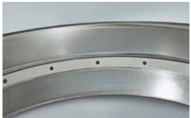
Фото 8.2 Деталь: Наружное кольцо двухрядного конического роликоподшипника Симптом: Вмятины на поверхности следов вращения Причина: Инородные частицы попадают на рабочую поверхность
