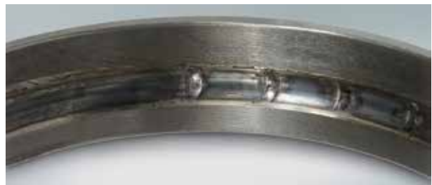
Фото 14.4 Деталь: Наружное кольцо с фото 14.3 Симптом: Изменение цвета следов вращения, оплавление на интервале, соответствующем шагу шариков Причина: Чрезмерный предварительный натяг
