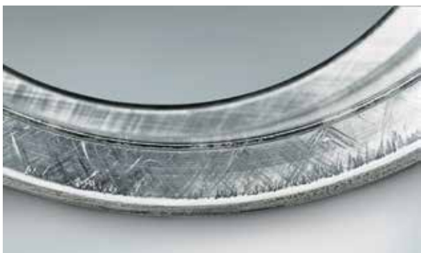
Фото 3.5 Деталь: Внутреннее кольцо сферического упорного роликоподшипника Симптом: Задираание на поверхности внутреннего кольца Причина: Частицы износа, попадающие на поверхность, и чрезмерная осевая нагрузка
